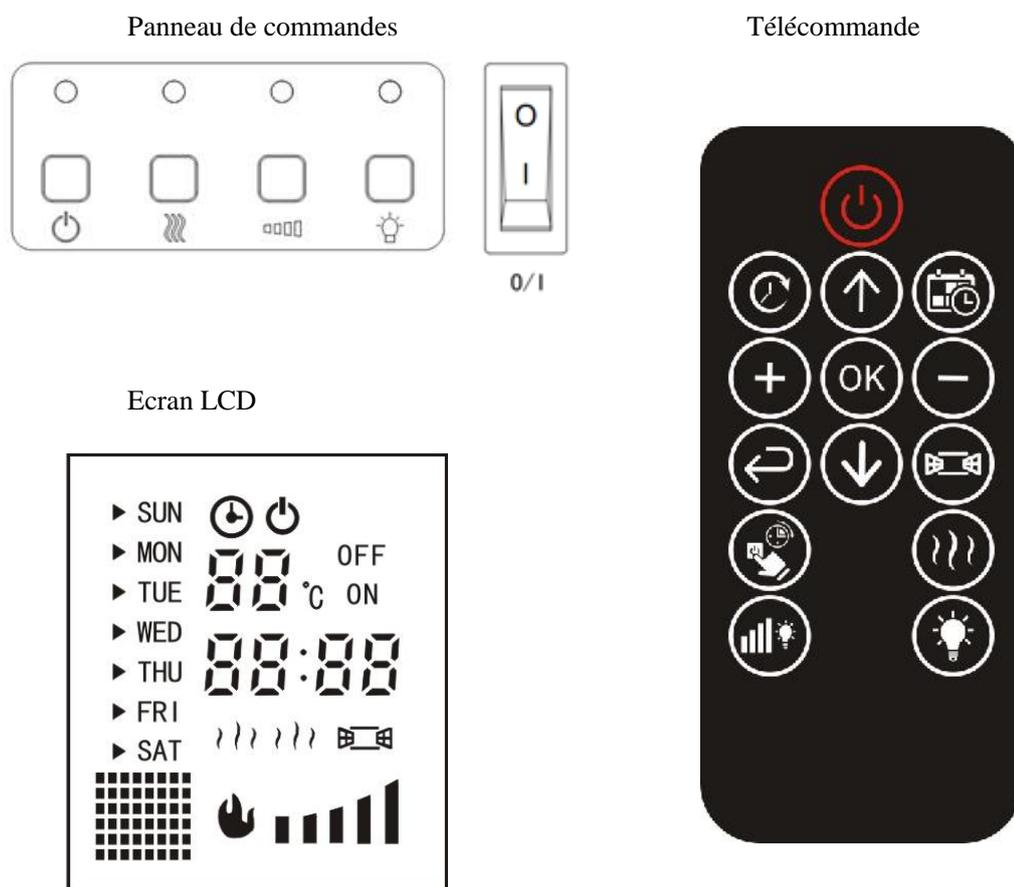
**O/I:** Appuyez sur cet interrupteur pour allumer l'appareil. Lorsque le commutateur O / I est désactivé, toutes les autres fonctions s'arrêteront même si les touches sont en position ON.
